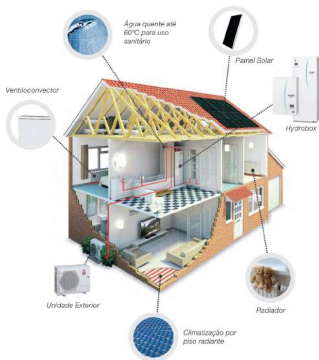
Diagrama de funcionamento: AQS + Ventiloconvectores/Radiadores
