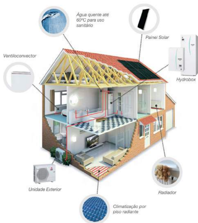
Diagrama de funcionamento: AQS + Ventiloconvectores/Radiadores
