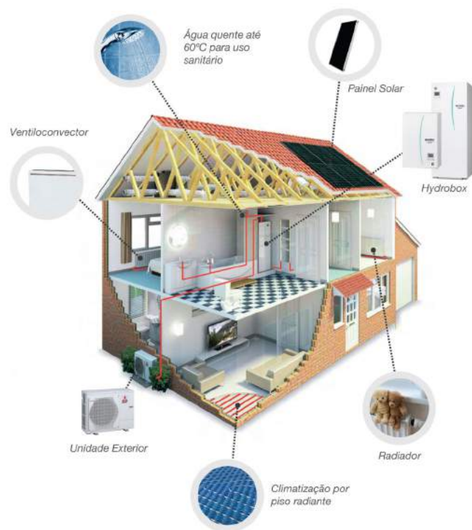
Diagrama de funcionamento: AQS + Ventiloconvectores/Radiadores
